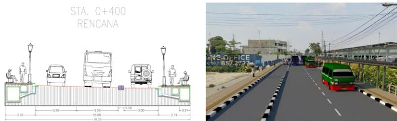
Gambar 7. Ilustrasi Rencana Transfer Point Pada Jl. Mayor Oking
