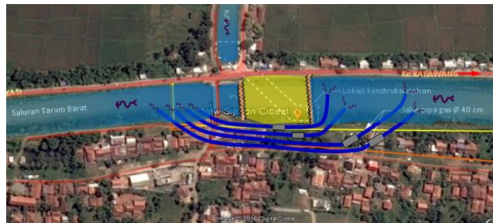
Gbr 5. Alternatif-2 Metode Pengaliran STB dengan Pompa (sumber Penulis)
