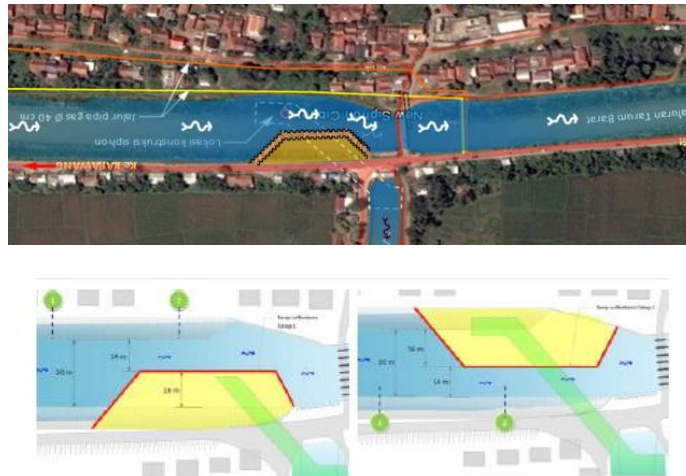
Gbr 6. Alternatif-3 Metode Temporary Cofferdams (sumber Penulis)
